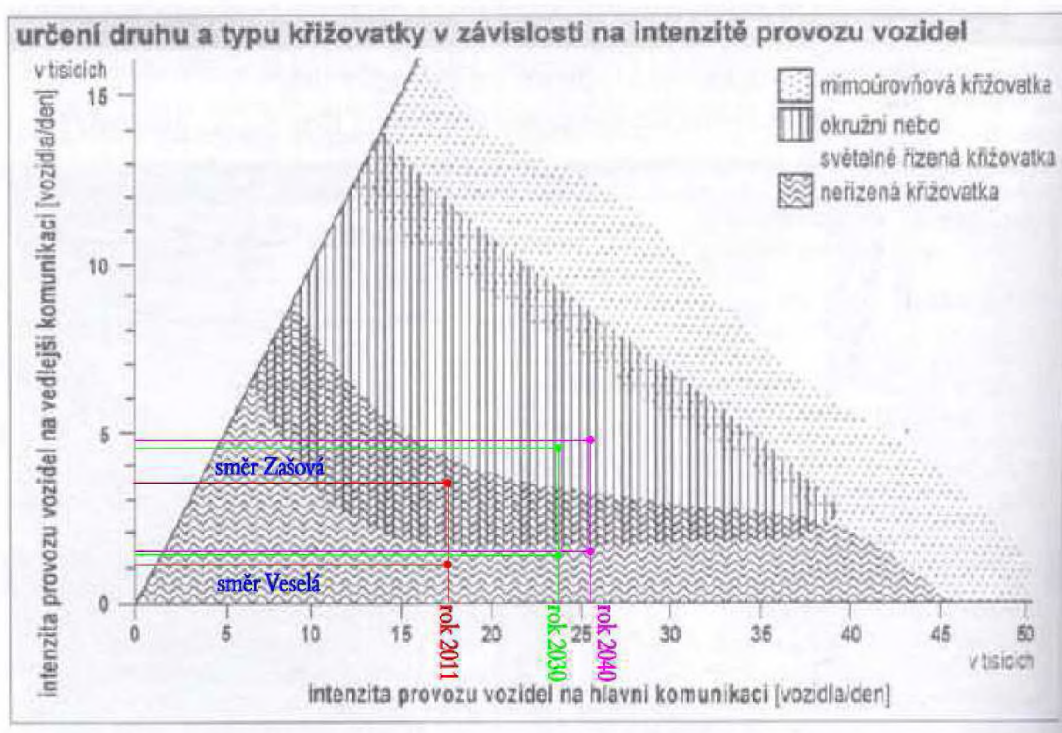
Obrázek 2. Informativní určení druhu a typu křižovatek (zdroj ČSN 73 6101, obrázek 2 před její novelizací v roce 2007)
